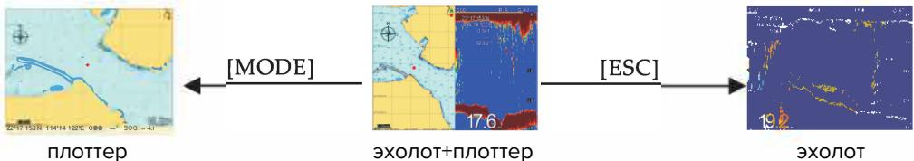
Пример 2. Если вы находитесь в режиме ПЛОТТЕР + ЭХОЛОТ, то при нажатии клавиши [ESC] экран перейдет в режим ЭХОЛОТА.
