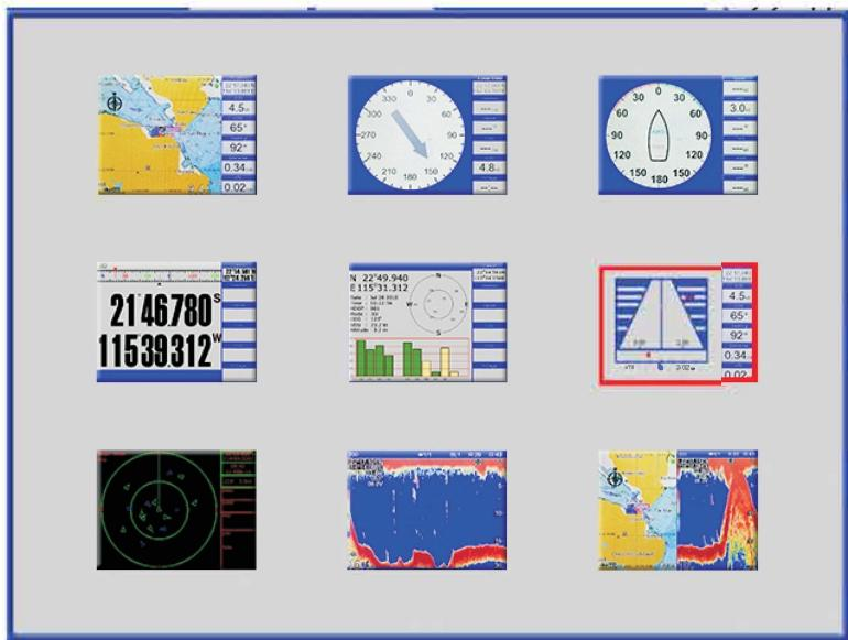
Вы можете использовать клавиши со стрелками для выбора режима отображения и нажать [ENT], чтобы войти в этот режим отображения.
