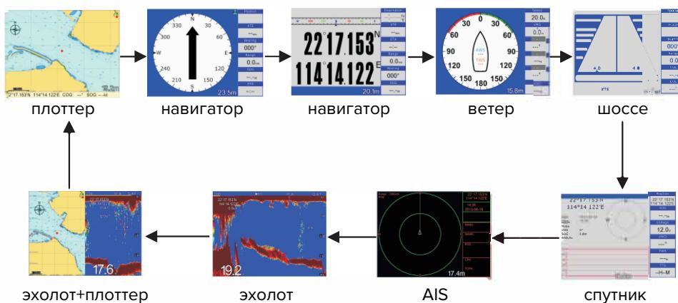
Нажмите клавишу [MODE], чтобы выбрать режим отображения. При каждом нажатии клавиши режим отображения меняется в последовательности, показанной выше.
