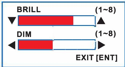
2. Нажмите [] или [] для регулировки яркости ЖК-дисплея.
